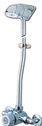
PRESTO ALPA 80 TEMPORIZADO TERMOSTATICA CIERRE AUTOMATICO 30 s +5s-10s ROCIADOR ANTIVANDALICO CAUDAL: 10 l/m REGULABLE
