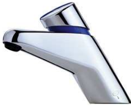
PRESTO 2000 LAVABO APERTURA POR PULSADOR CIERRE AUTOMATICO CAUDAL: 4 l/m REGULABLE CONEXIÓN: 1/2 M
