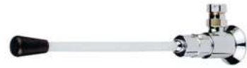
PRESTO 712 LAVABO MURAL GERONTOLOGICO APERTURA POR PALANCA CIERRE AUTOMATICO 15 s ± 5 CAUDAL: 6 l/m REGULABLE CONEXIÓN: 1/2 M
