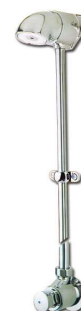
PRESTO 75 CUNJUNTO FIJO PULSADOR CAUDAL: 10 l/m REGULABLE CIERRE AUTOMATICO 30 s +5-10 1/2" M ROCIADOR ANTIVANDALICO
