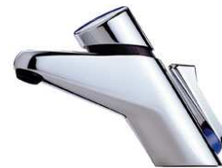
PRESTO 2020 LAVABO MEZCLADOR PALANCA APERTURA POR PULSADOR CIERRE AUTOMATICO 15 s ± 5 CAUDAL: 5 l/m REGULABLE
