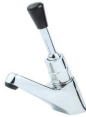
PRESTO 415 LAVABO GERONTOLOGICO APERTURA POR PALANCA CIERRE AUTOMATICO 15 s ± 5 CAUDAL: 6 l/m REGULABLE CONEXIÓN: 1/2 M
